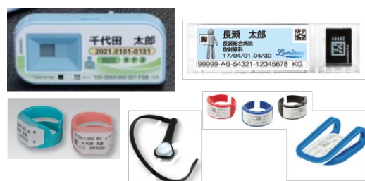
外部の線量測定サービス会社から供給される 個人線量計の例 (検出素子は TLD、ガラス、 OSL、個体飛跡検出器など社によって異なる)
