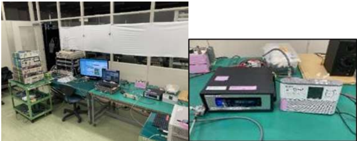
図 2-1 受信機基本特性評価試験の様子(左：試験機材、右：FM ラジオ受信機)
