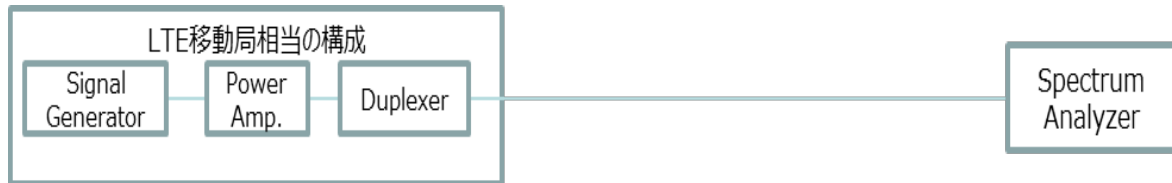
(a) LTE 移動局実力値の測定系（過去の検討時の測定系）
