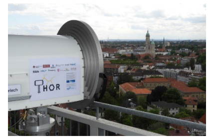
ThoR:世界初の300GHz双方向無線伝送システムの実証実験
