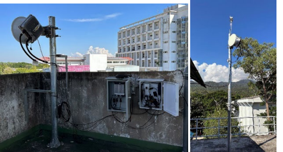
タイのチェンマイ大学に設置しているミリ波帯無線機と振動・気象センサ
