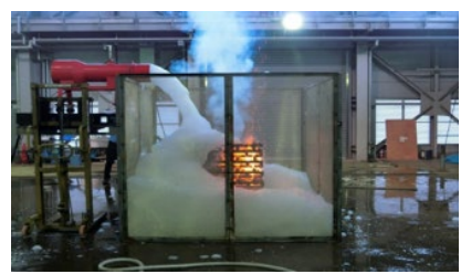
【泡消火実験の様子】
