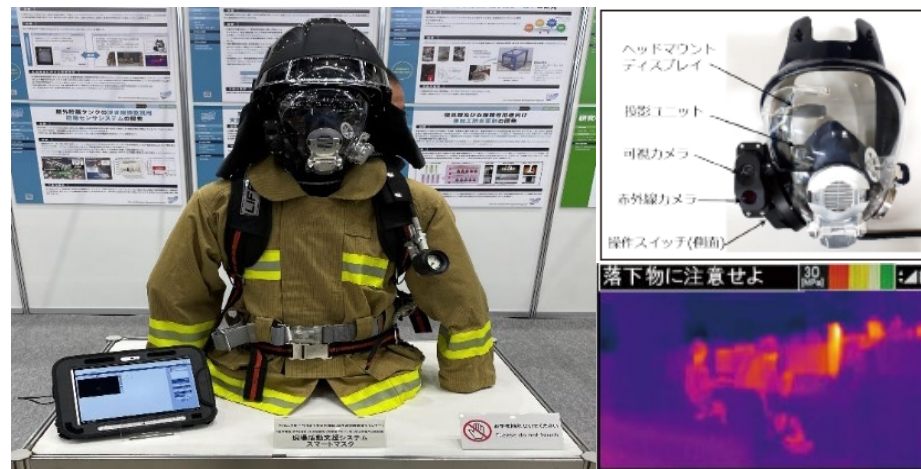
【競争的研究費による研究開発の一例】 現場活動支援システム(スマートマスク) ・赤外線映像等による活動支援 ・隊長と隊員間での視覚画像の共有 等
