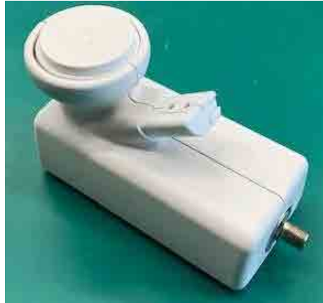
図4. 2-4 ①局発周波数をハイローカル（13.903GHz）による対策モデル 試作品
