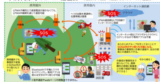
久万高原町のLPWA通信網 ～中継網により親機へ、親機からはインターネット通信網へ～
