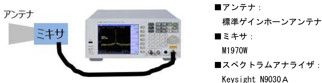
図6 漏洩電力測定設備
