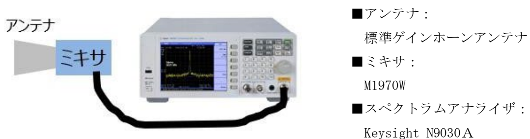
図6 漏洩電力測定設備
