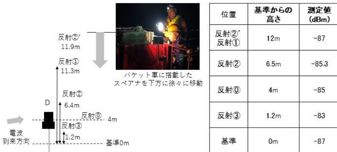
図 14 滑走路面反射電力測定結果
