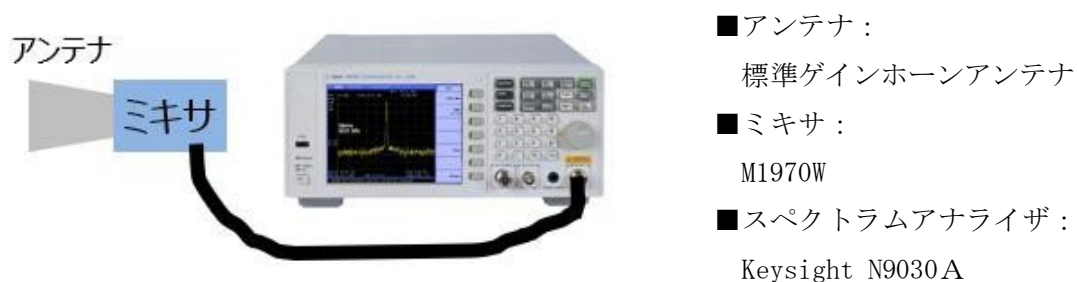
図6 漏洩電力測定設備
