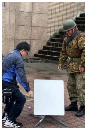
Starlinkの設置 (フリーWi-Fi提供)
