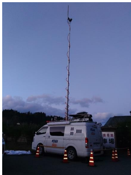
移動基地局 (車載型・可搬型) 43台
