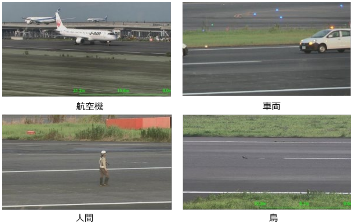
図 10 レーダー検知後のカメラ自動撮影画像結果
