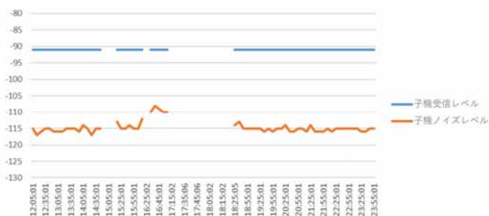
図 4-20 2022 年 4 月 5 日 12:00 から 4 月 6 日 0:00 子機における受信レベルとノイズレベルの変動
