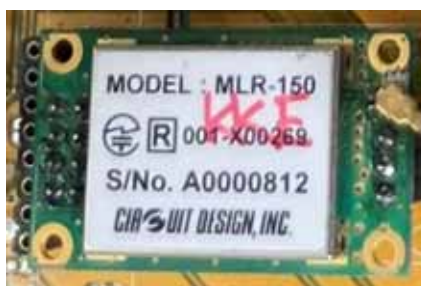
図 3-6 150MHz 帯 LPWA 技術 LoRa 変調方式で動作可能な無線機外観
