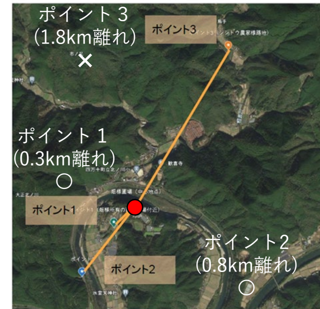
429MHz帯特定小電力LoRa®の通信状況例 山を越え1.8km離れた地点とは通信できない
