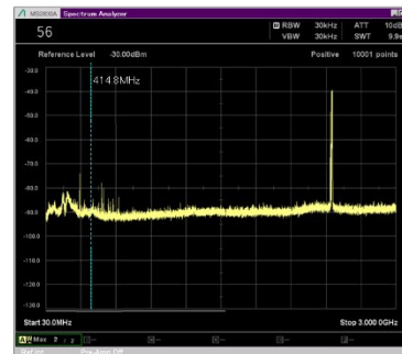
図4-107 ドローンノイズ測定結果 DJIドローン 垂直偏波 30MHz~3GHz
