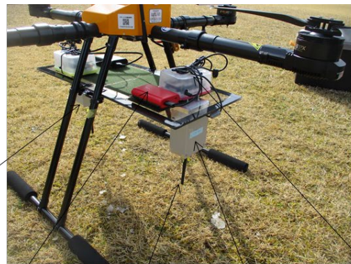
受信機用バッテリー (モバイルバッテリー) アンテナ 400MHz帯狭帯域 LoRa®受信機 PC (ラズパイ)
