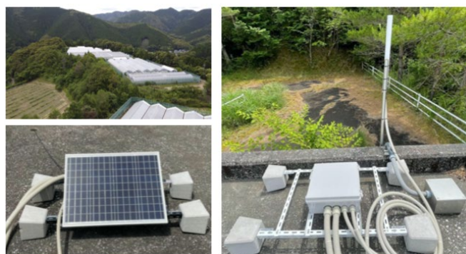
図1-2 429MHz帯特定小電力LoRa ® を使用した水位計
