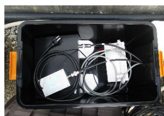
図4-9 1 水位計長期データ取得 測定状況
