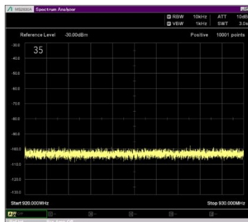
図4-106 ドローンノイズ測定結果 マゼックスドローン 垂直偏波 920~930MHz
