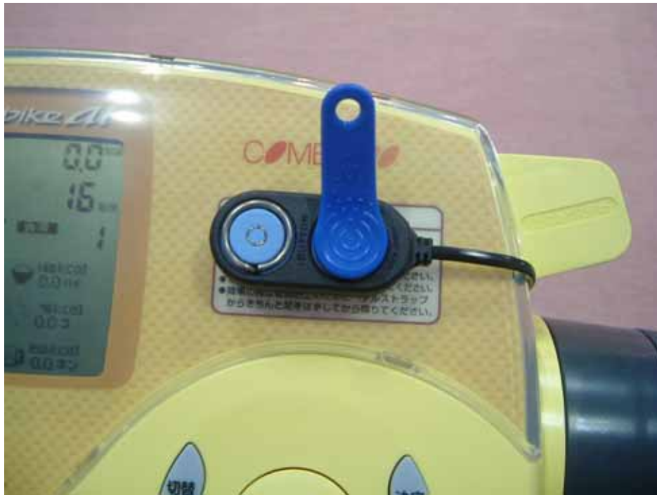
図 4.1-3 iButton receptor (型番 DS1402D-DR8)
