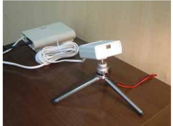
図 4.2-2 モニター宅に設置された IPv6 照度計ノード
