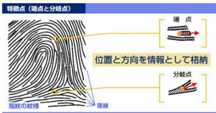
一人一人の指紋のもつ特徴点やその位置、方向を情報として抽出し、その情報を登録します(図左)。その後、誰かが認証を行う度に照合を行い、登録されてあるものだけに介護情報のデータベースへのアクセスを許可します(次ページ図参照)。
