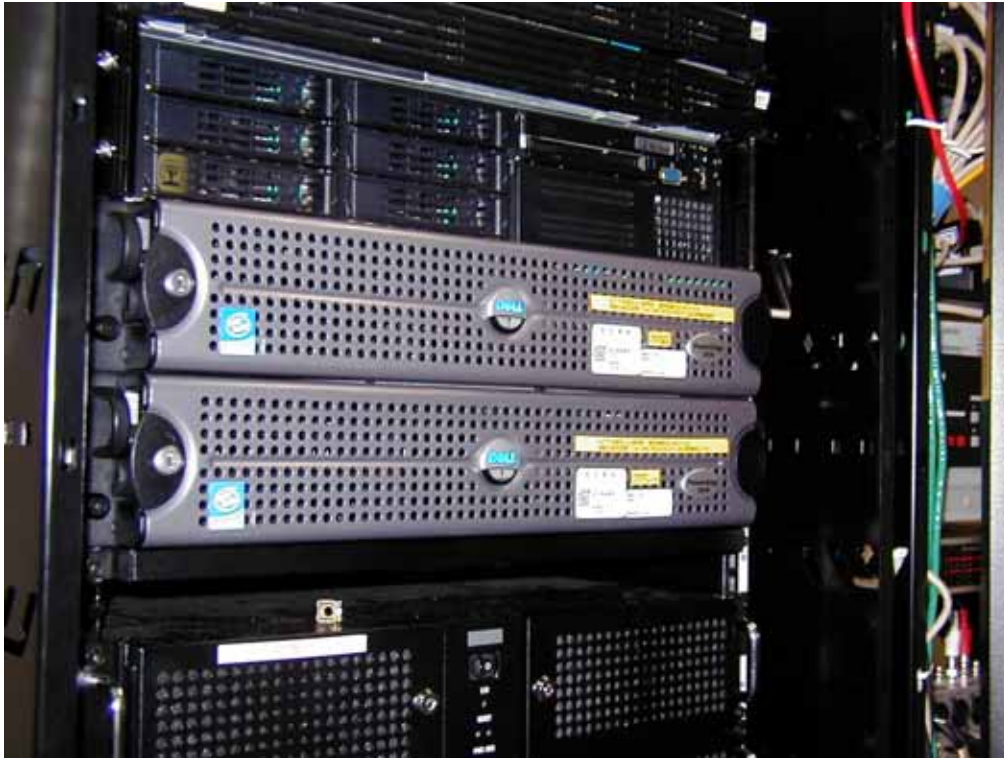
図 5.4.2 PC ルータ (下段) 及び QoS 評価用端末 1 (上段)
