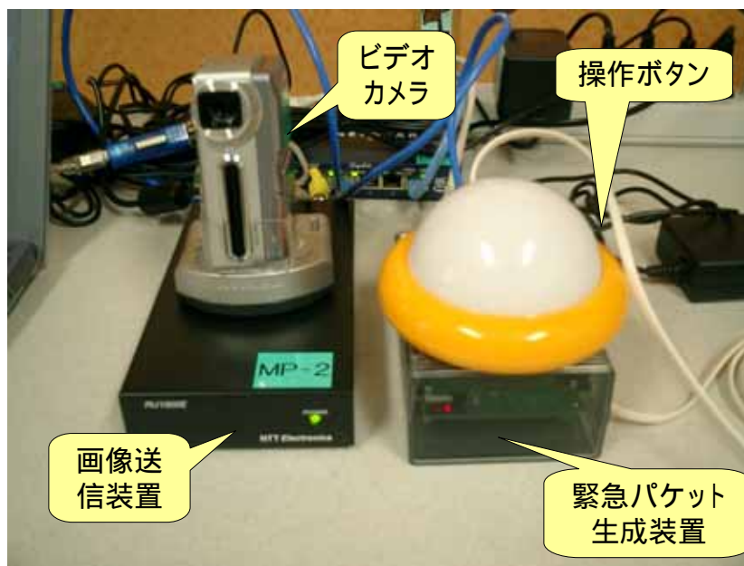
図6 緊急通信パケット生成装置および周辺装置一式
