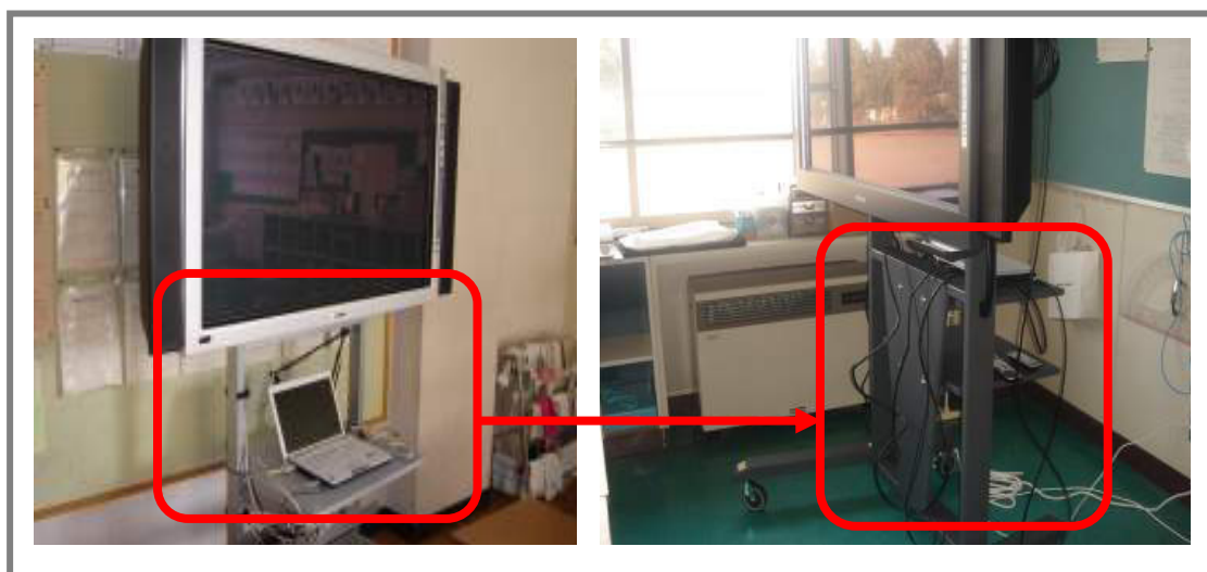
図 5-24 IWB 付属パソコン台の設置例
