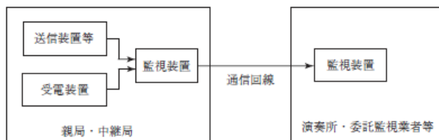
第14図 監視・制御所や委託業者により集中監視を行う場合の例
