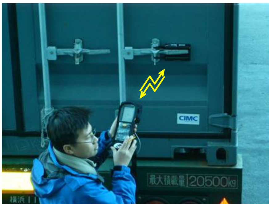
図 2.3.6 倉庫における可搬型の 433MHz 帯インテロゲータの利用シーン
