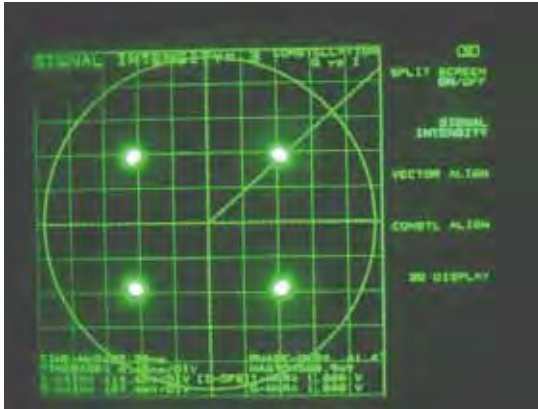
写真 4-1 QPSK IF 折返しの コンスタレーション
