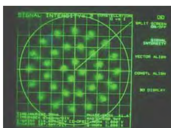
写真 7-6-2 32APSK(2/3) 擬似中継器 折返しのコンスタレーション
