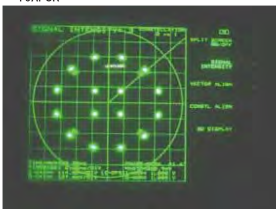
写真 6-1-1 16APSK(1/4) IF 折返しのコンスタレーション
