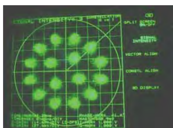
写真 6-5-2 16APSK(3/5) 擬似中継器 折返しのコンスタレーション
