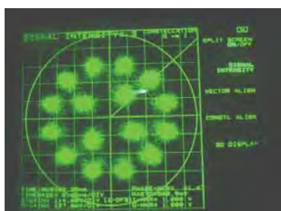
写真 6-2-2 16APSK(1/3) 擬似中継器折返しのコンスタレーション
