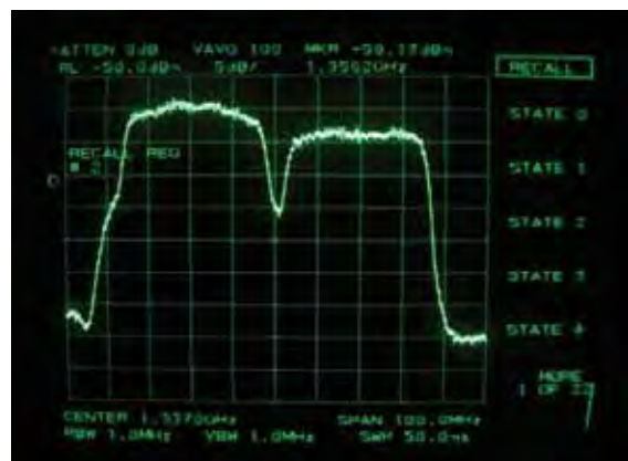
写真 1-5 与干渉 8PSK(15ch) ⇒ 被干渉 16APSK(17ch)
