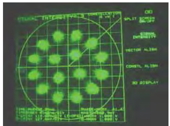
写真 6-7-2 16APSK (3/4) 擬似中継器 折返しのコンスタレーション
