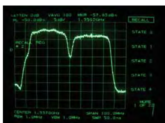
写真 1-6 与干渉 8PSK(15ch) ⇒ 被干渉 8PSK(17ch)
