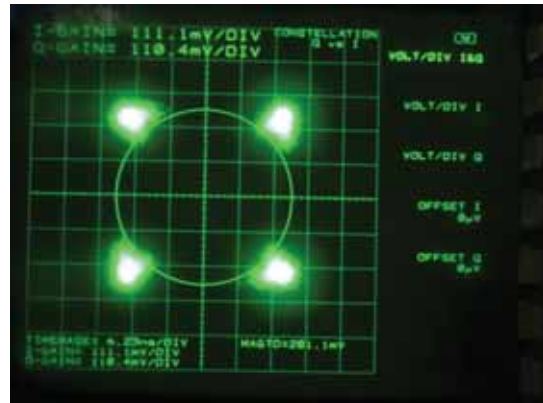
写真 9-2 \pi/2 シフト BPSK 衛星伝送実験のコンスタレーション
