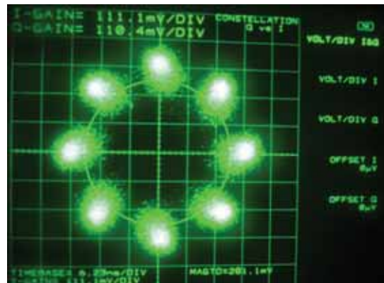
写真 11-2 8PSK 衛星伝送実験の コンスタレーション
