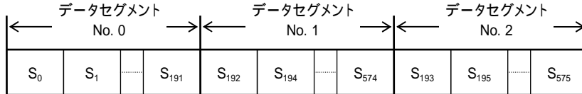
インターリーブ後のシンボル配置
