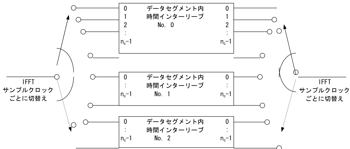
図3.5.11-1 3セグメント形式の時間インターリーブの構成(告示第四十一号 別表第二号 別記第1)
