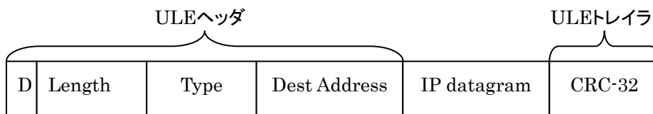
図 4-47 ULE パケット構造
