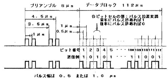
図1 モードS拡張スキッタ信号波形
