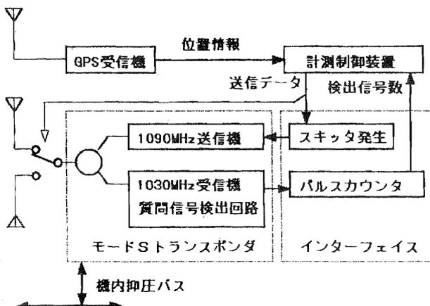
図 2. 搭載実験装置の構成
