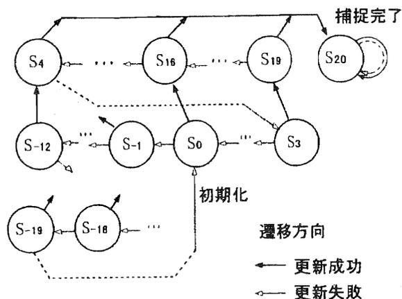
図1. 初期捕捉処理の状態遷移モデル
