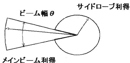
図 3. 水平面内アンテナパターンのモデル
