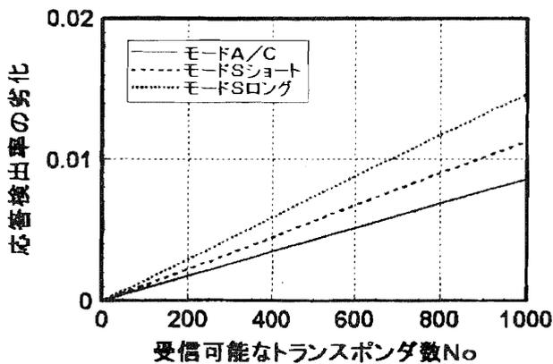
図4. SSRの応答検出率劣化
