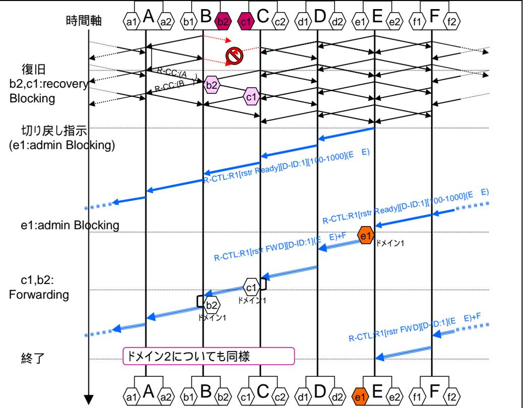
図 a-18 故障復旧後の切り戻し
