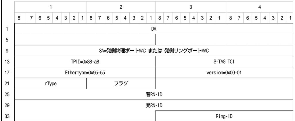
図 a-8 ERP 制御フレーム共通構成
