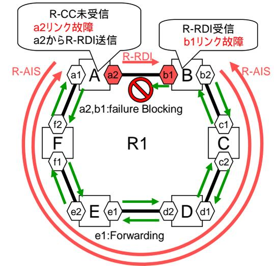
図 a-6 故障発生時のポート制御
