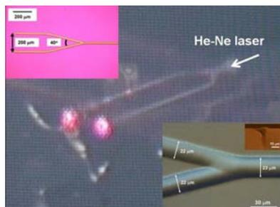
図2 レーザー照射でガラス表面に書き込まれた Y 字分岐結晶ラインの光導波実験
