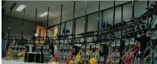
図 1 情景観測システム (100 ノードの円弧型配置例)
