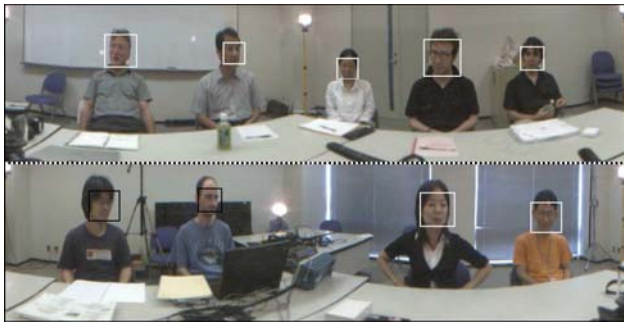
図2 キャプチャーシステム出力の1例、全方位カメラによって人を認識し、トラッキングする
