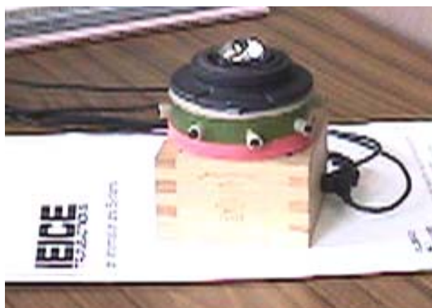
図1 キャプチャーシステムの1例、全方位カメラにマイクアレイによるデータ収集装置
