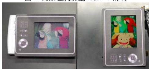
図 2 試作した反射型フルカラー液晶ディスプレイ (左：従来方式、右：新方式)
