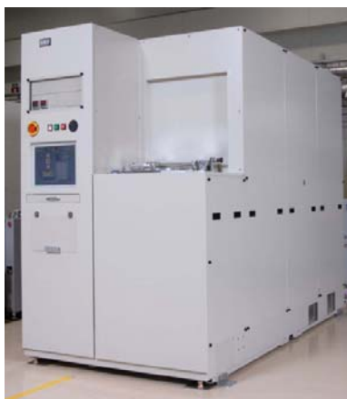
図2 製作した 300mmφウェハ対応反応性イオンエッチング装置。
