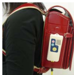
図 1 開発した子機 児童が所持する発信器。移動時には 3 分毎にパケットを送信
