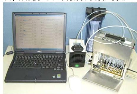
図 1. 電磁弁高速開閉方式による最新版匂い調合装置
