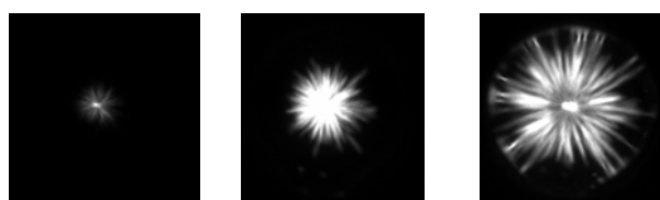
0-5 [ns] 10-15 [ns] 15-20 [ns] 図 1.本研究において開発された大気圧プラズマの放電時の様子(露光時間: 5 [s])
