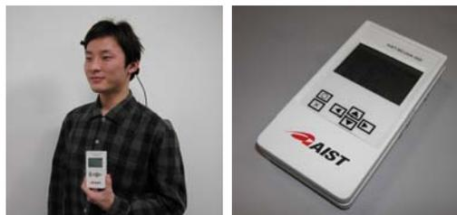
図 1 申請者らが開発した骨導超音波補聴器
