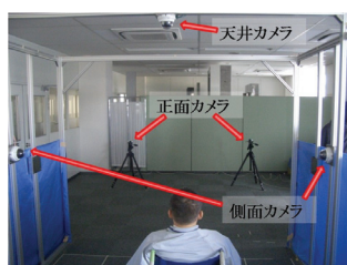
図 3 試作した見守りゲート (1方向検出型)
