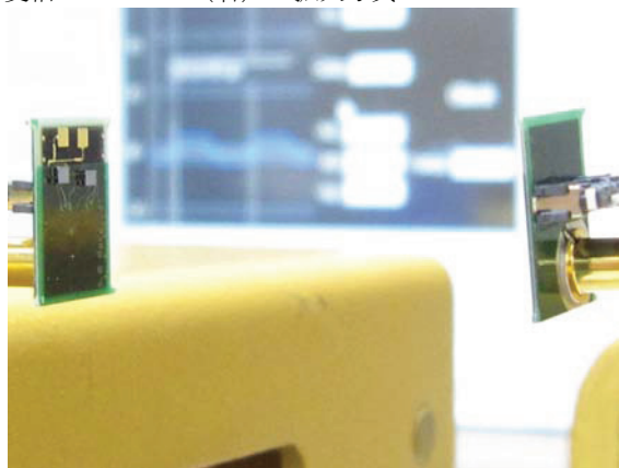
図 5 アンテナ一体型超小型送受信モジュールを用いた通信実験
