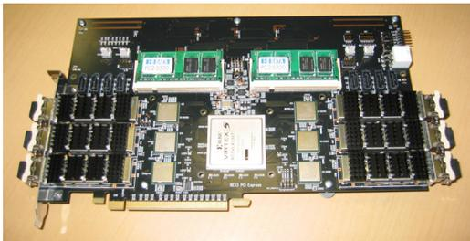
図2. 拡張可能60Gbps 光ポート搭載 FPGA ボード (REX3)
