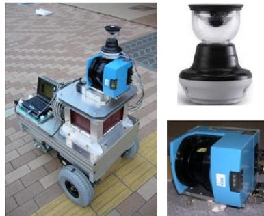
距離センサと全方位センサを搭載した移動ロボット
