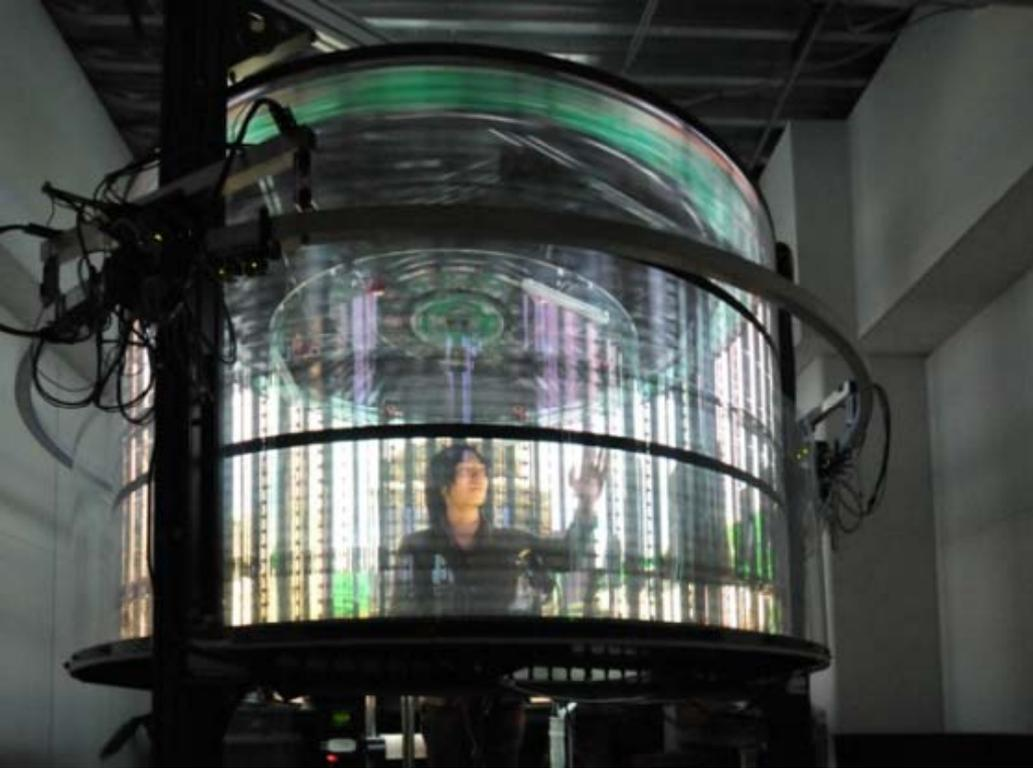
代理ロボットTELESAR4の相対位置にあわせてTWISTER周囲を回る可動カメラが遠隔参加者の表情をリアルタイムで取得伝送し、それを再帰性投影技術（RPT）を用いて代理ロボットTELESAR4に投影することで、現地参加者は遠隔参加者の存在感を感じながらコミュニケーションできる。
