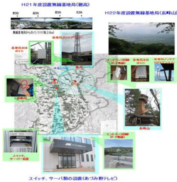
図1 安曇野市高速無線通信実験ネットワークの概要
