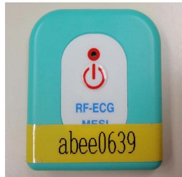
心電データ、3軸加速度データ、体表温度、心拍数の測定が可能
