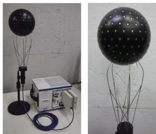
図 3 構築したバーチャル音空間創成システムの全体像 (左) と收音装置として構築した 252 ch マイクロホンアレイ (右)
