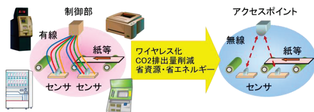
図 1 ハーネスのワイヤレス化の概念図
