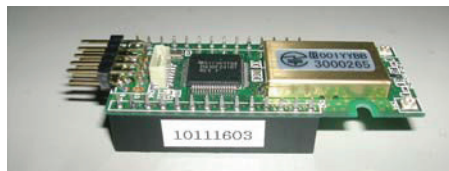
図3 開発した無線モジュール(950MHz)
