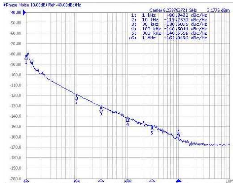
図 1 6GHz 帯・電圧制御発振器の位相雑音の実測値
