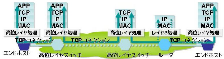
図2. 高位レイヤスイッチングアーキテクチャ
